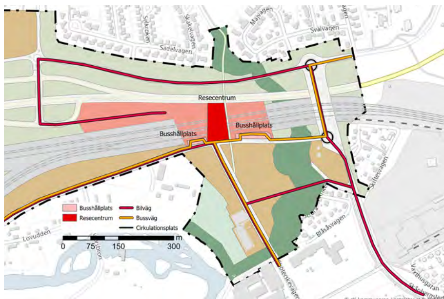
Figur 6. Trafikalternativ 1a med endast kollektivtrafik på den nya kopplingen till Skånbergsleden, ny koppling för personbilar skapas i kvartersstrukturen.
