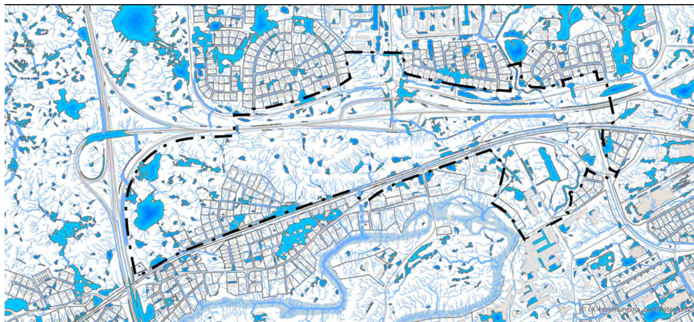
Figur 27. Karta från dagvattenutredning. Visar rinnvägar och lågpunkter där vatten ansamlas vid kraftiga regn.
